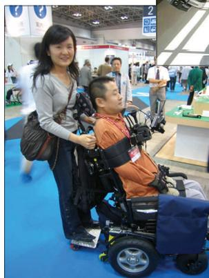
図4 後方に乗せてチンコントロールで移動
