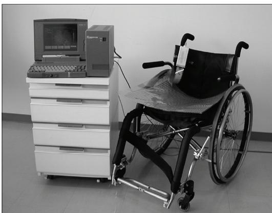
図6 座面圧力値の測定装置
