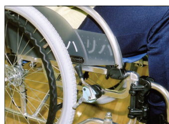
図7-11 プラスチックが塗装されたハンドリム
