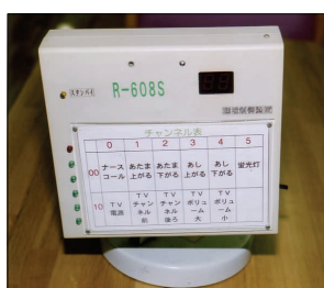
図7-8 環境制御装置
