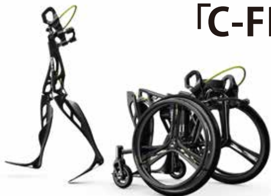
図 C-FREX(イメージ) 下肢に装着したまま車いすに乗り(右)、歩ける環境のところへ移動して立つ(左)
