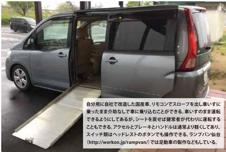
自分用に自社で改造した国産車。リモコンでスロープを出し車いすに乗ったまま介助なしで車に乗り込むことができる。車いすのまま運転できるようにしてあるが、シートを戻せば健常者が代わりに運転することもできる。アクセルとブレーキとハンドルは通常より軽くしており、スイッチ類はヘッドレストのボタンでも操作できる。ランプバン仙台 (<http://workon.jp/rampvan/>) では足動車の製作などもしている。
